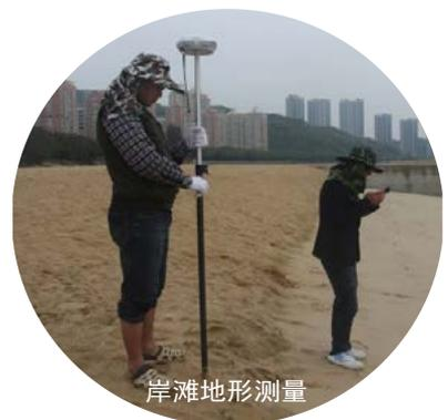
海图，一般要求水下地形测量比例尺不低于 1:5000，岸滩地形测量一般不低于 1:1000。在测深过程中，导航定位准确度应优于 10m。在水深小于 30m 时，水深测量准确度应优于 0.3m；在水深大于 30m 时，水深测量准确度应优于水深值的 1%。
