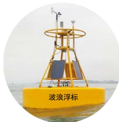
量避开陡岸。抛设浮标（或传感器）处的水深一般不小于 10 m，海底平坦，尽量避免急流区。传感器或测波浮标布放后应立即测定布放点的水深、布放时的潮高、布放点相对于岸上观测场地（或接收点）的方位、水平距离并记录布放时间。
