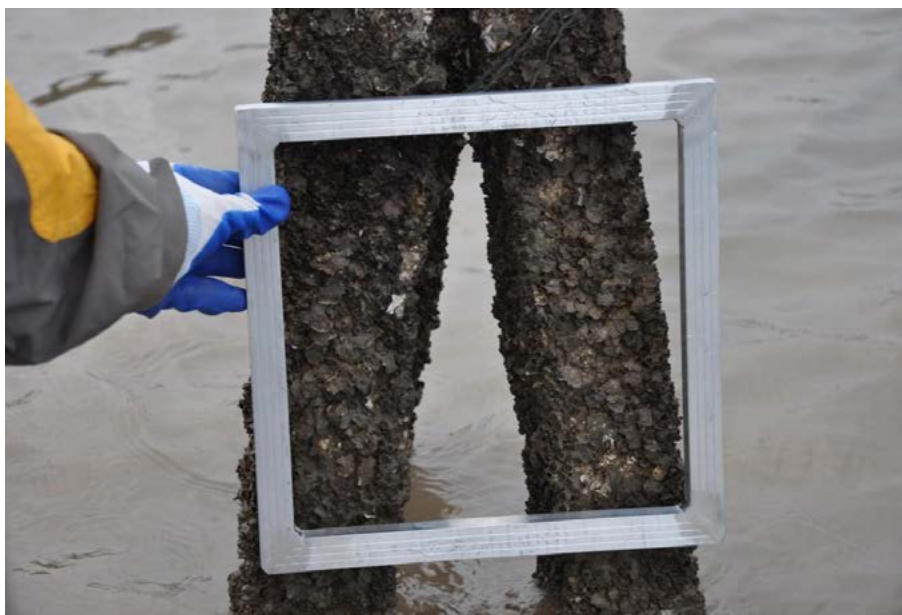
图 28 人工礁体固着效果监测（图片来源：自然资源部第二海洋研究所 程杰）
